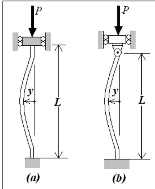
**Figura 2.3.** Pandeo de columnas con (a) ambos extremos empotrados y (b) un extremo empotrado y el otro unido por pasador.
