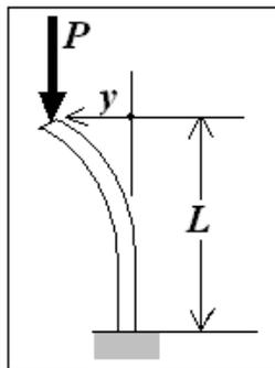
**Figura 2.2.** Pandeo de una columna con un extremo empotrado y el otro libre.
