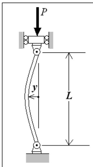
*Figura 2.1. Pandeo de una columna conectada por pasadores.*
