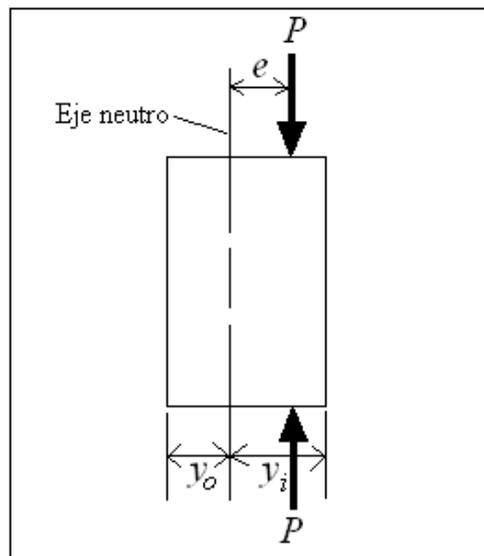
Figura 5.1. Elemento corto a compresión.
