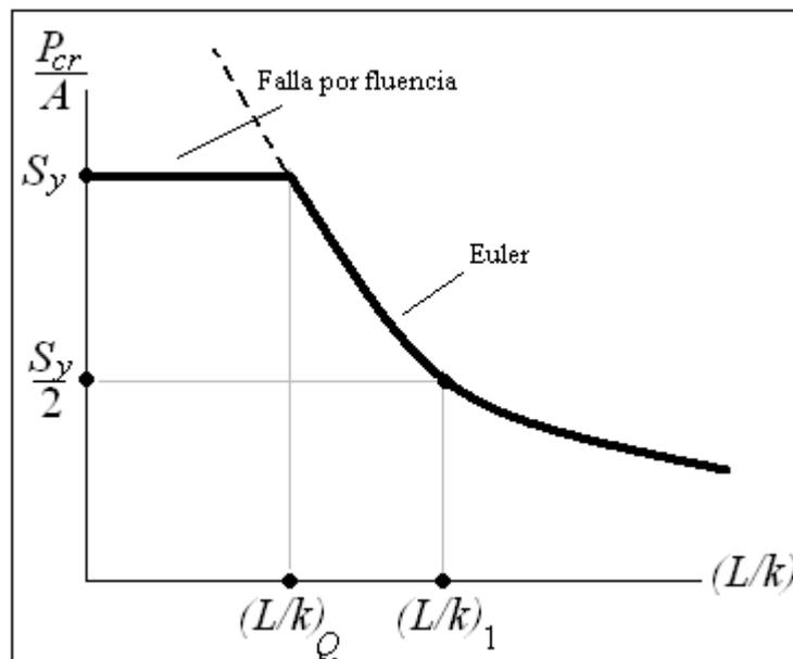
**Figura 3.1.** Carga crítica por unidad de área en función de la razón de esbeltez.
